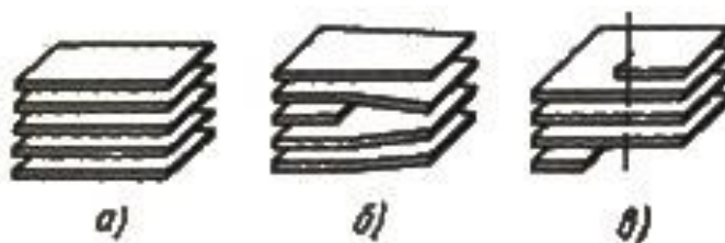
Рис. 2.6. Схема строения кристалла, показанная в виде семейства атомных плоскостей: а — идеальный кристалл; б — кристалл с краевой дислокацией; в — с винтовой дислокацией
