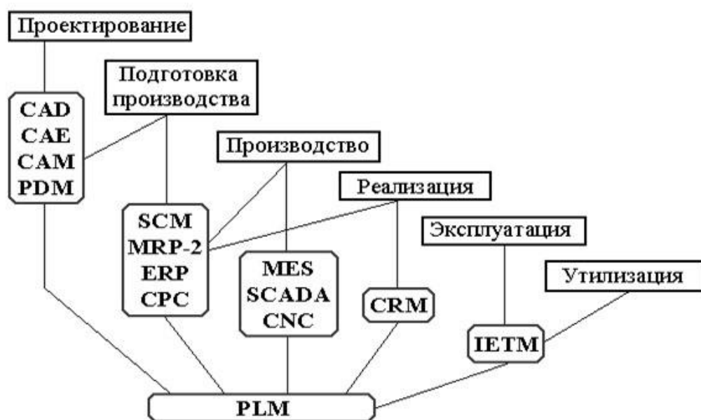
Рис. 5.6. Основные типы автоматизированных систем
