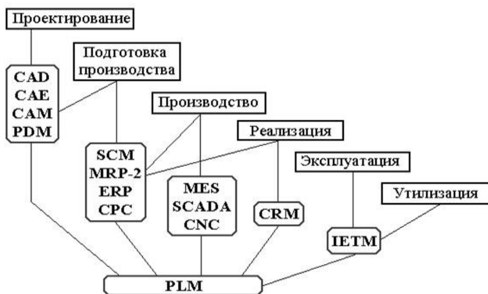
Рис. 5.6. Основные типы автоматизированных систем
