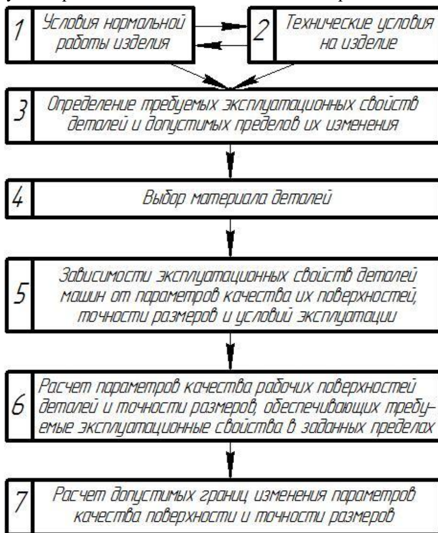
Рис. 5.3. Алгоритм решения конструкторской задачи по обеспечению требуемых эксплуатационных свойств деталей машин
